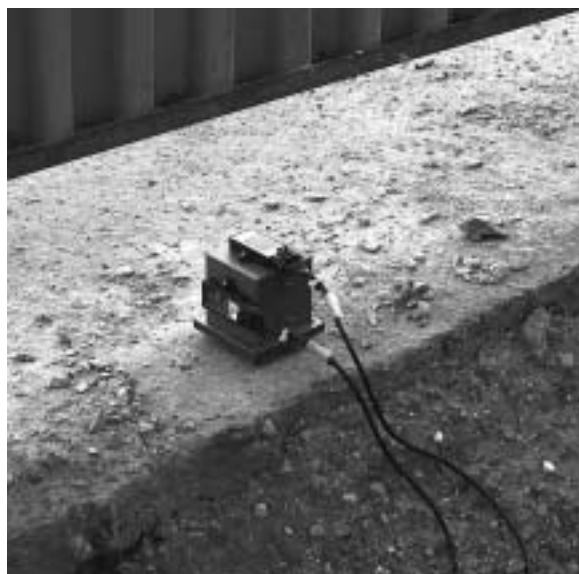
Obr. 2. Fotografie osazení měřicích kostek pro měření přenosu vibrací
